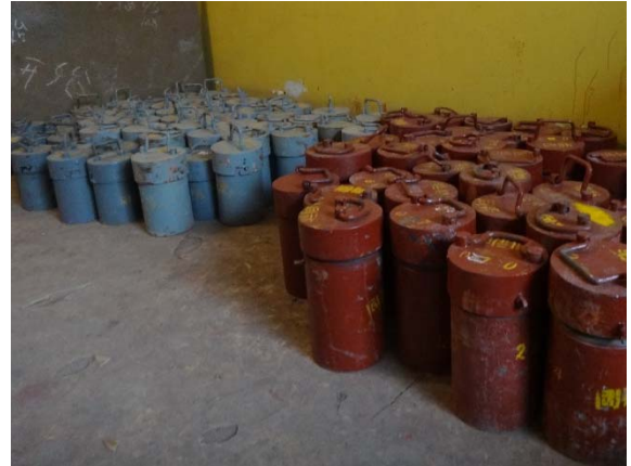
河南同新公司放射源储存库内放射源及放射性同位素采用铅罐储存
