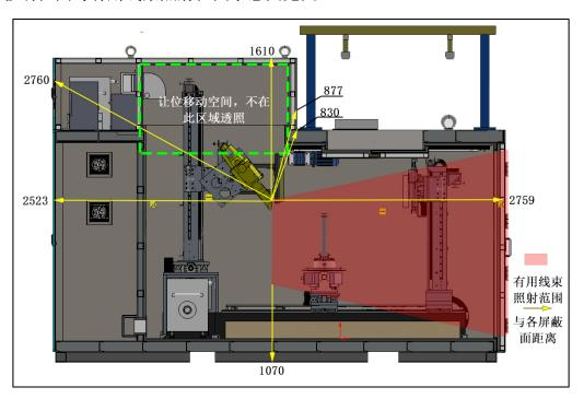
图 9-4 有用线束照射范围示意图(正视图)
