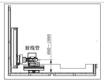
图 9-13 射线源-探测器结构单元示意图 (侧视图)
