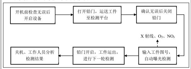
图 9-6 焊接棒阳极射线数字成像检测系统工作流程及产污环节图
