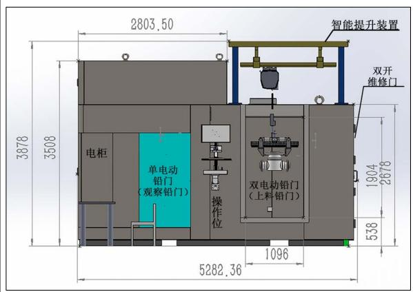
图 9-1 设备正视图(正立面)
