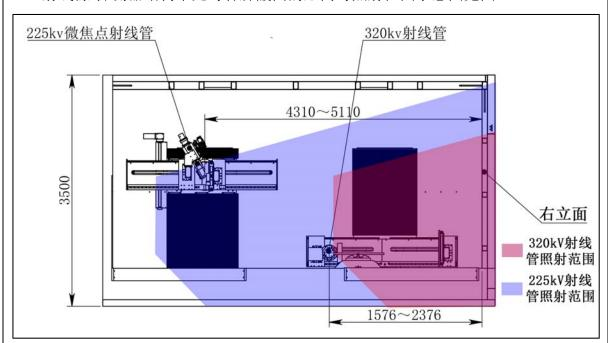
图 9-11 SLM 检测系统射线管活动范围示意图(正视图)
