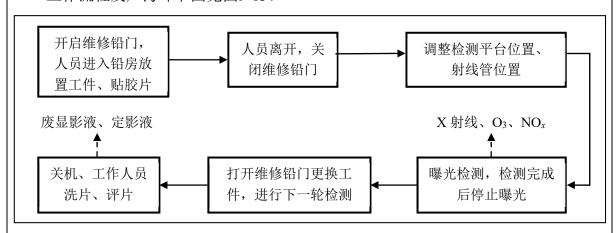
图 9-15 SLM 检测系统人工检测模式工作流程及产污环节图
