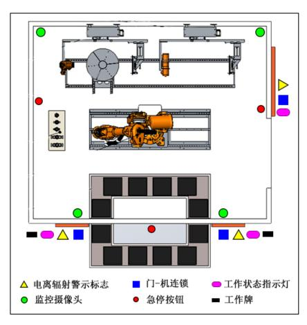
图 10-6 铅房防护设计示意图
