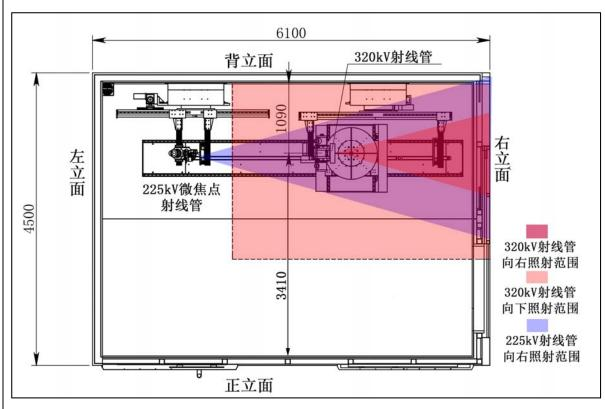
图 9-12 SLM 检测系统射线管活动范围示意图 (俯视图)
