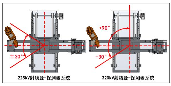
图 9-10 射线源-探测器结构单元活动范围示意图
