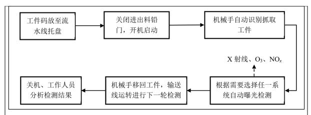
图 9-14 SLM 检测系统全自动检测模式工作流程及产污环节图
