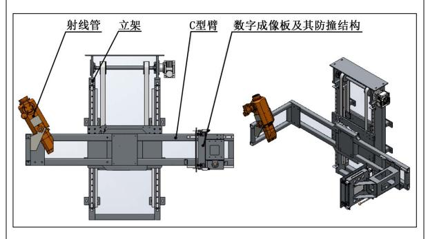
图 9-9 射线源-探测器结构单元示意图
