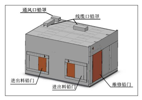
图 9-7 检测系统外观示意图
