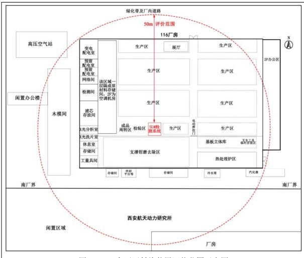
图 7-2 老厂区射线装置评价范围示意图
