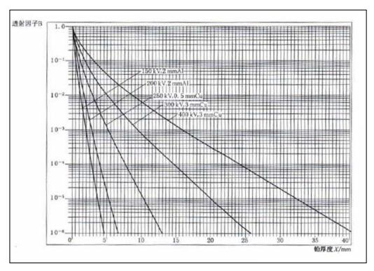
图 11-1 X 射线穿过铅的透射
