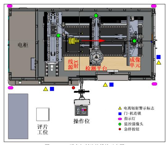
图 10-4 设备辐射防护措施示意图
