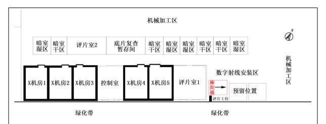
图 1-4 焊接棒阳极射线数字成像检测系统安装情况示意图
