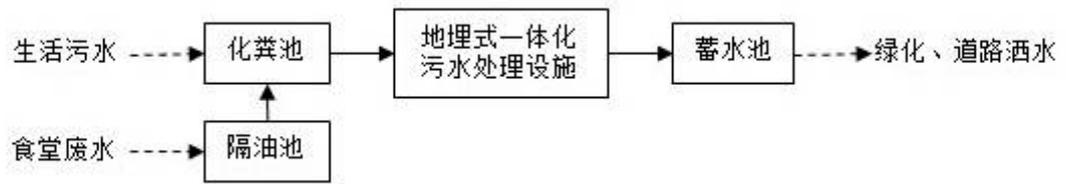
图 7-3 生活污水处理工艺流程图
